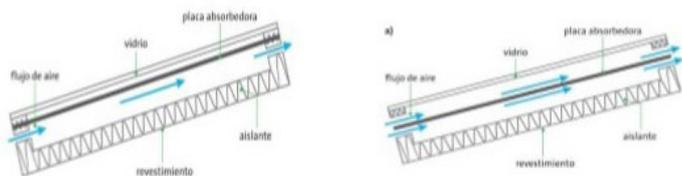
Figura 3. Captador solar para calentamiento de aire: a) circulación del aire entre el absorbedor y el aislamiento térmico, b) circulación de aire por ambos lados del absorbedor<sup>17</sup>
