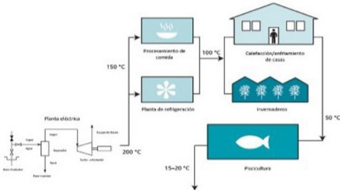
Figura 7. Producción en cascada de la energía geotérmica<sup>54</sup>
